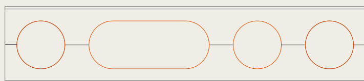
Figure 10 : Exemple de poutre ACB® avec ouverture rallongée
